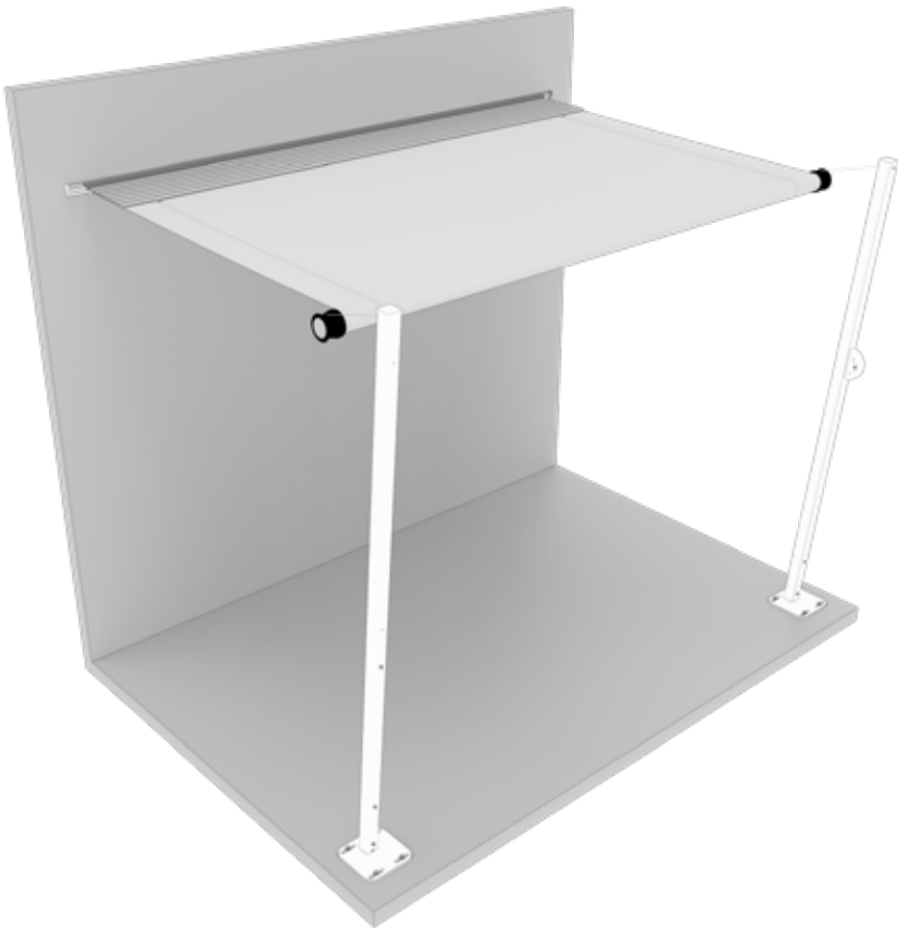
MONTAGE MIT ZWEI SÄULEN AN GELÄNDER – SHADE INOX
